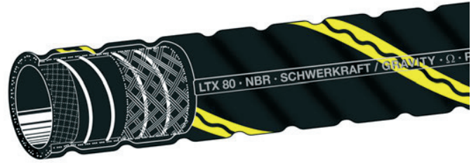
Kennzeichnung : Gelbe Spiralmarkierung und Prägebandstempelung LTX 80 · NBR · SCHWERKRAFT / GRAVITY · Ω · PN 4 BAR · ELAFLEX © 03.08
