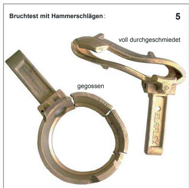
TW-Kupplung China: Risse und Poren nahe der Oberfläche
