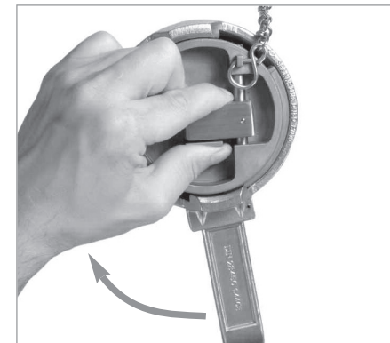
MK 80 Mutterkupplung durch Drehen des Spannrings lösen
